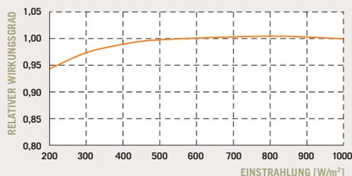
Die typische relative Änderung des Modulwirkungsgrades bei einer Einstrahlung von 200 W/m<sup>2</sup> im Verhältnis zu 1000 W/m<sup>2</sup> beträgt weniger als 6 % (gemessen bei 25 °C, AM 1,5 Spektrum).
